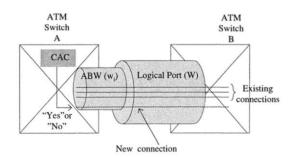
Gambar 4 Operasi CAC pada ATM
